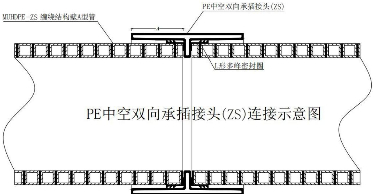
PE双向承插接头(ZS)及L形多峰橡胶密封圈
